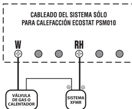
**NOTAS DEL DIAGRAMA DEL CABLEADO:**
